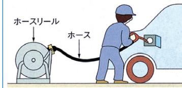
注) 流体が灯油の場合、長時間放置すると、ホース内の可塑剤と化学反応して稀に灯油が黄色に変色することがあります。
