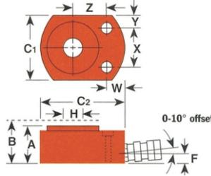
4.5tより139.2t、ストローク11.1mmより5.9mmまで。クリアランスの狭い場所でのジャッキアップ作業等に素晴らしい効力を発揮します。油圧ホースの接続を容易にする為、RLS50以外のシリンダーはカプラーが上方に向けて角度をつけて取り付けられています。
