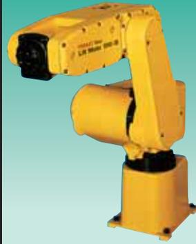
LR Mate 100iBは高速ハンドリング用の5軸ミニロボットです。工作機械のワーク着脱や小物部品の箱詰め、ダイキャストマシンへの離型剤塗布などに最適です。LR Mate 200iBは自由度の高い6軸ミニロボットです。組立作業やバリ取り、アーク溶接などに最適です。作業エリアを拡大したロングアームタイプ、クリーンクラス100タイプ、洗浄作業向け防水タイプ、磨き仕上げ向け低バックラッシュタイプもラインアップしました。
