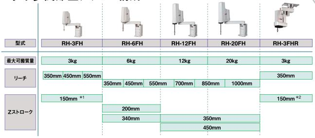
\*1:クリーン仕様機:120mm \*2:クリーン仕様機、防水仕様機:120mm
