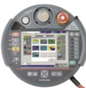
標準ティーチングボックスの機能に加えモニタ機能を向上させた高機能版ティーチングボックスです。プログラム編集、パラメータ設定などRT ToolBox2相当の操作を可能としデバッグ作業を効率化します。
