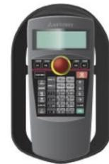
プログラムの作成・修正・管理や動作位置の指示、ジョグ送りなどおこないます。安全に使用いただくため3ポジションイネーブルスイッチを装備しています。ロボットが複数台ある場合、1台のティーチングボックスをつなぎ換えてご利用できます。電源を遮断した状態でつなぎ換えます。
