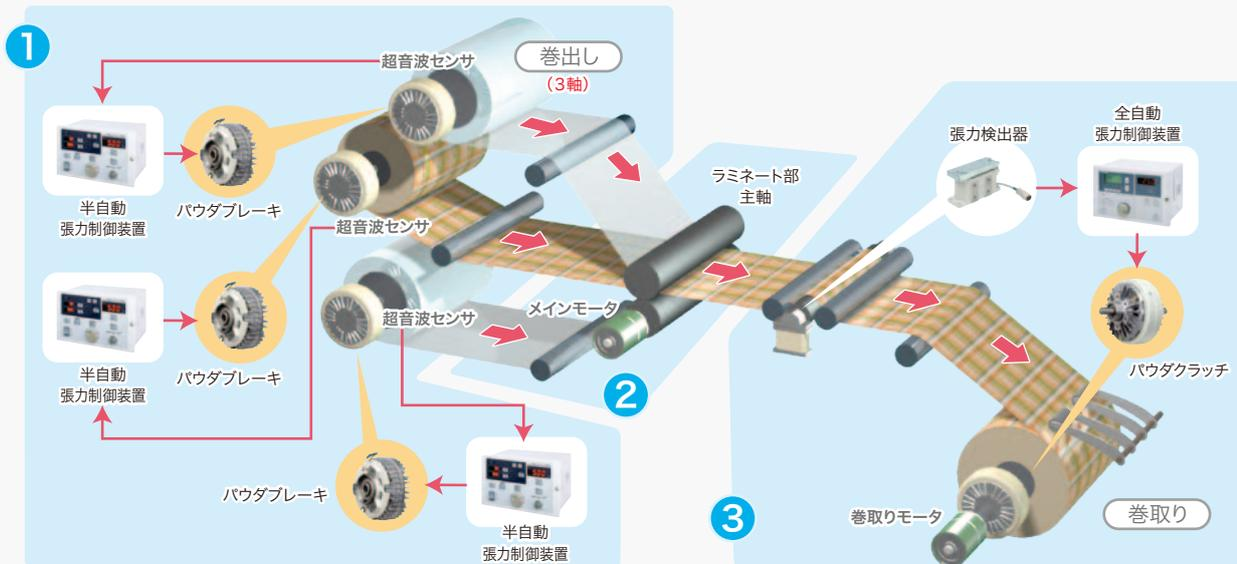
ラミネート部の張力を一定にすることにより、ソリ・シワを防止し、ラミネート部の貼り合わせ品質を良くします。貼り合わせ工程の違いによりドライラミネータ、ウェットラミネータ、ホットメルトラミネータ、押しラミネータなどの種類があります。
