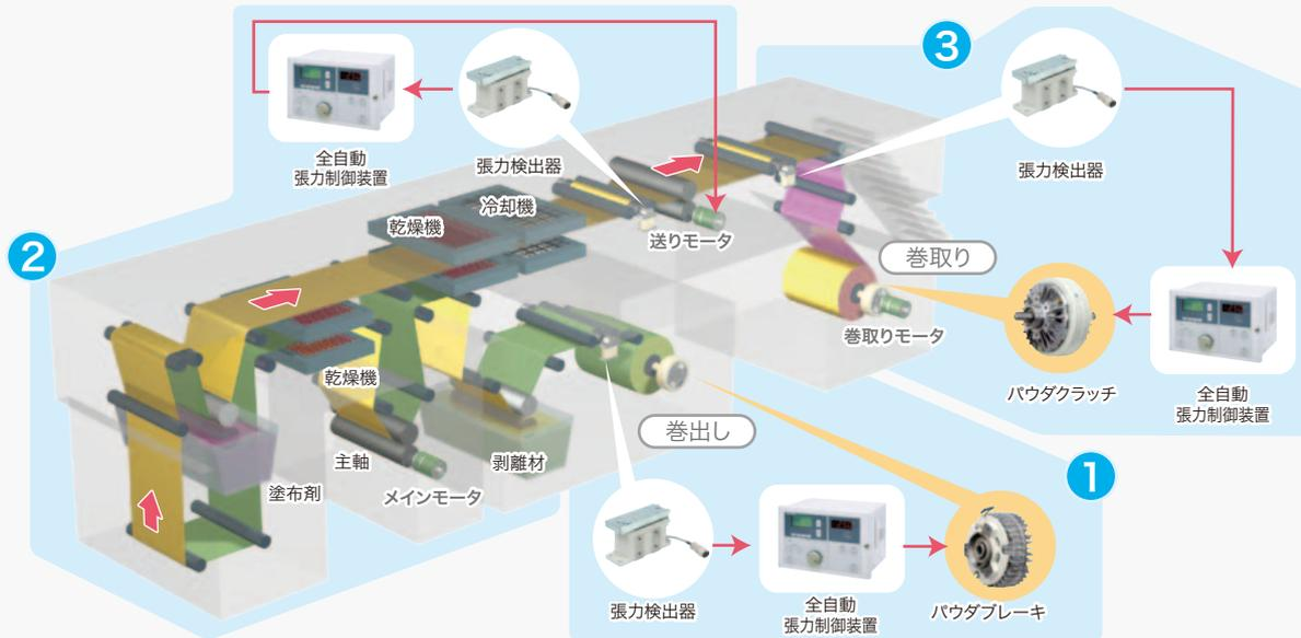
フィルムに塗布するコーティング剤の塗りムラを防止するために、高度な制御技術が必要です。また、塗布後に乾燥工程があるため、温度変化によりフィルムの伸縮の影響もあり、巻取り・巻出しには張力制御が必要です。
