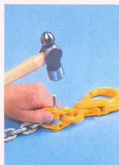
チェーン・金具を上図のようにはめ込み、ハンマーでピンを打ち込む。
